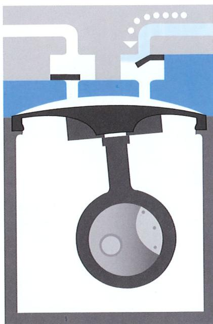
↑ Schéma de principe d'une pompe à membrane
